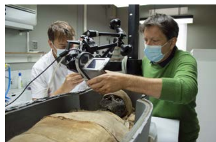
Philippe Salinson, photographe et radiologue, et Thomas Calligaro, ingénieur de recherche au C2RMF, procèdent à l'analyse des yeux factices de la Momie Setjaimengaou par fluorescence de rayons X. © C2RMF / Vanessa Fournier © C2RMF / Agathe Jagerschmidt-Séguin
